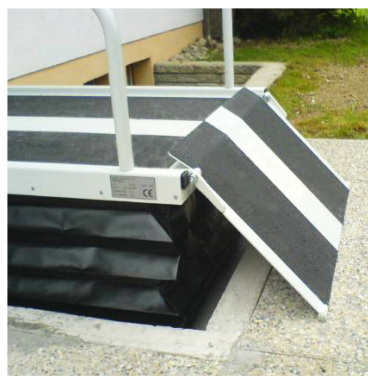
Option: Manuelle Auffahrrampe , klappt beim Heben nach unten und bietet somit einen Abrollschutz
